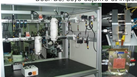
Instalación de caracterización de monoceldas. Fuente: CIDAUT 2007
